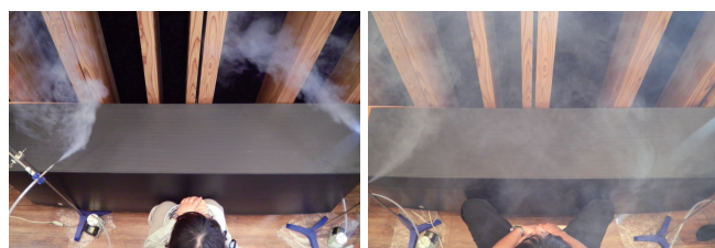
排気スリットのファン運転/停止時の非喫煙者周囲状況。 左: 排気ファン運転時、煙がそれぞれの排気スリット側に流れ、非喫煙者方向への煙を抑えることができる。 右: 排気ファン停止時、煙が拡散する。 図1・2。左写真2点提供/清水建設
